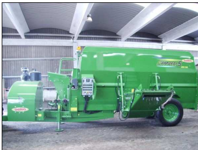
Homogeneïtzadora de FV i FORM de la planta de compostatge
